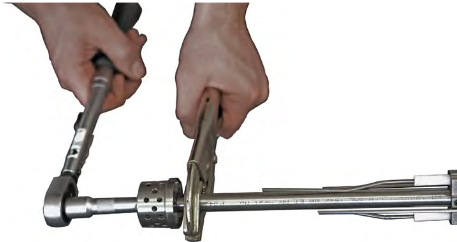
Fig. 6-12 Monter l'injecteur avec stabilisateur de flamme
