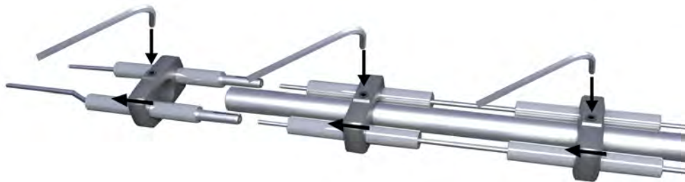
Fig. 6-8 Etape 6 Remplacer les pièces d'usure du brûleur d'allumage
