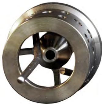
Fig. 6-16 Support d'électrode positionné correctement dans le stabilisateur de flamme
