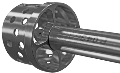
Fig. 6-13 Mauvais montage de l'injecteur gaz
