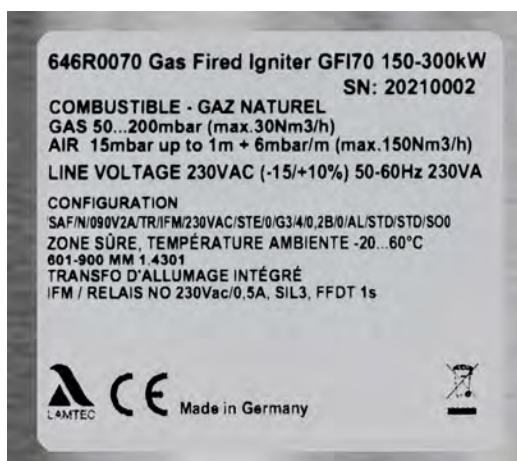
Fig. 3-3 Exemple plaque signalétique sur le brûleur d'allumage LAMTEC GFI
