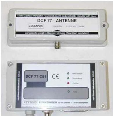
En lieu et place de l'horloge temps réel intégrée, on peut connecter également une horloge radio via l'interface RS232, dont le signal sera délivré à l'intégralité du système.
