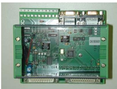
Les messages NEMS peuvent être transposés en protocole bus de terrain standard via un processeur de communication connecté au BUS SYSTEME LAMTEC (Profibus, Interbus-S, CANopen, Modbus).
